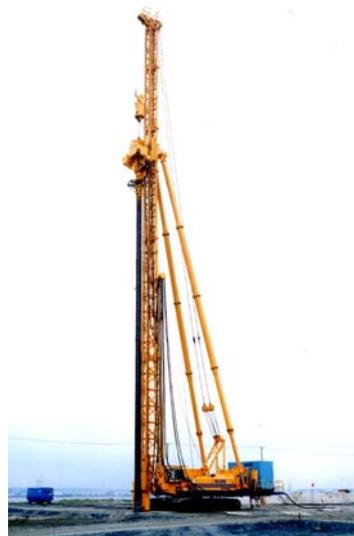
施工機姿図（振動締固めタイプ）
